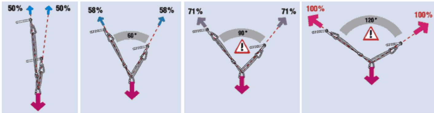
Le schéma ci-dessus montre la répartition de la force de choc sur les points en fonction de la configuration du relais: pour éviter de trop solliciter les broches, attention à l'angle formé par l'anneau qui relie les deux points.
